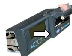
1. Levante la ventana del módulo de la impresora para abrir el frente de la impresora.
