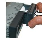
4. Vuelva a colocar cuidadosamente el módulo de la impresora en el termógrafo.
