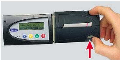
1- Presione ligeramente hacia arriba y tire cuidadosamente del módulo de la impresora hacia delante.
